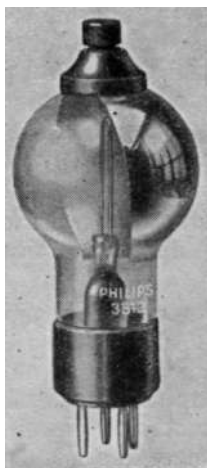
Obr. 168. Vakuový fotočlánek Philips.
