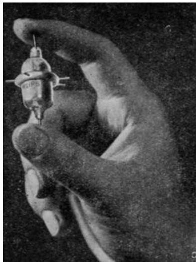
Obr. 165. Knoflíková elektronka je nejmenší používaná elektronka (Philips).
