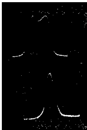
Obr. 249. Oscilogram rezonanční křivky jednoduchého obvodu a pásmového filtru.
