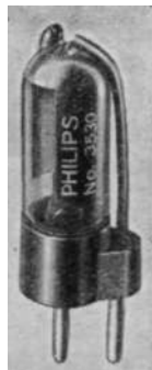
Obr. 169. Fotočlánek plynem plněný (Philips).
