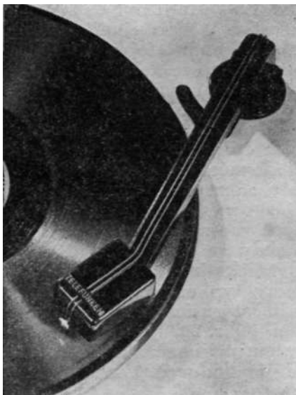
Obr. 193. Princip gramofonni přenosky. Obr. 194. Gramofonni přenoska Telefunken.
