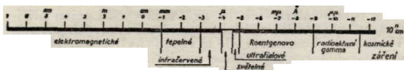
Obr. 273. Stupnice elektromagnetických vln.
