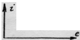
Obr. 25. Vektorový diagram na pětí a proudu na kondensátor.
