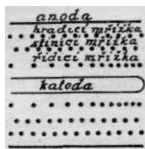
Obr. 155. Mřížka s různým stoupáním závitů.
