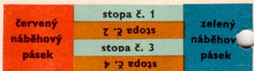
Při pohybu pásku od zeleného náběhového pásku k červenému je v činnosti stopa č. 1 nebo 3; při opačném pohybu, tedy od červeného k zelenému stopa č. 4 nebo 2. Stopa 1 (4) je zapojena přepínačem stop na magnetofonu v poloze „žlutá“ a stopa 3 (2) pak v poloze „červená“.
